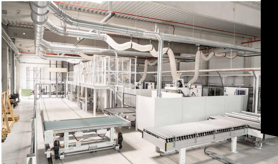
Insgesamt verfügt die Anlage über drei gleiche Nestingfräsen, die parallel arbeiten können und direkt und vollautomatisch vom Lager bestückt werden. Die fertig ausgefrästen „Nester“ werden von einem Quertransportwagen von den drei Fräsen abgeholt und zum Entnahmeband gefördert. Die Teile legen im Schnitt 100 m vollautomatisch in der Anlage zurück. Am Entnahmeband nimmt ein Mitarbeiter die Teile in Empfang und sortiert sie je nach weiterer Bearbeitung in Transportwägen.
