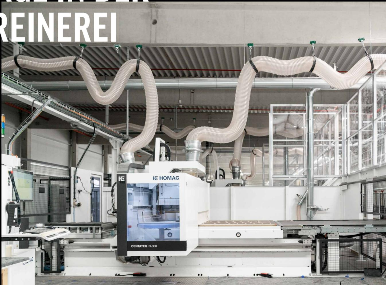
Im neuen Anbau unserer Schreinerei wird aktuell eine „Lager-Nestingzelle“ aufgebaut und betriebsbereit gemacht. Ein vollautomatisches Plattenlager legt die zu verarbeitenden Holzplatten auf eine von drei CNC-Fräsen, die im sogenannten „Nesting Verfahren“ Einzelteile aus den Platten fräsen.
